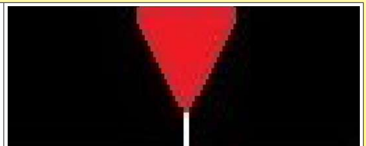
Unvollständige Schweißnaht mit Spalt an der Wurzel, die Korrosion begünstigt
